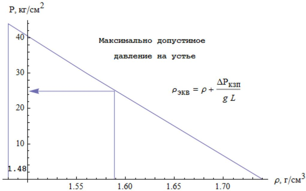
График зависимости MAASP от плотности бурового раствора
